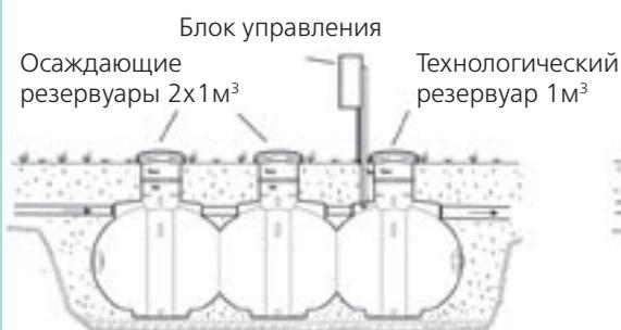
**«Urolog»-10 ре для обработки сточных вод дома на две семьи Urolog код 330110**
