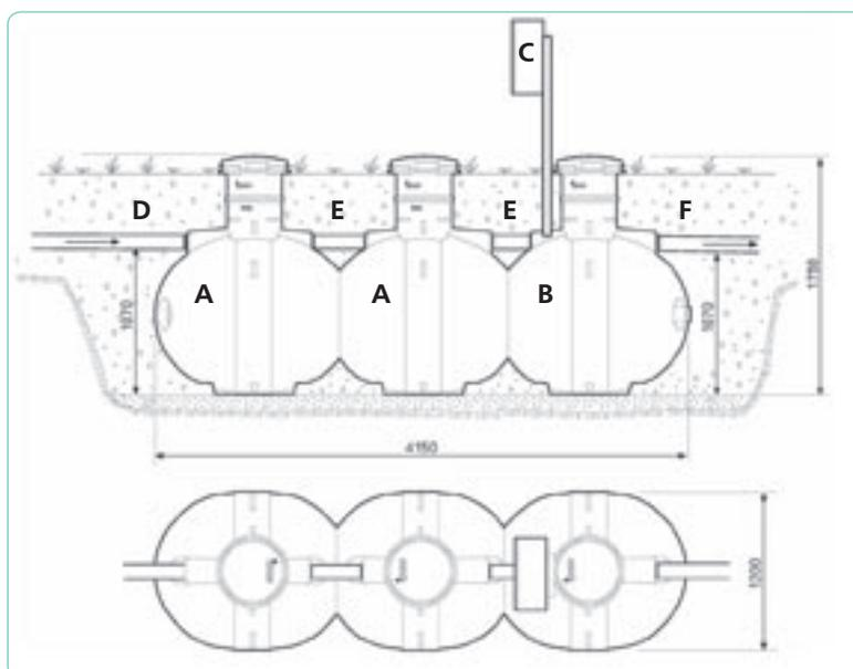
A – осадочные резервуары объемом (2x1м<sup>3</sup>)
