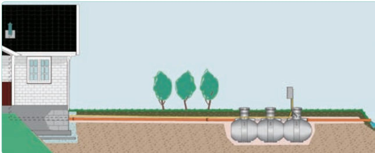
После очистки, нагрузка сточных вод на окружающую среду должна быть снижена по органическому веществу (BOD) минимум на 90 %, по общему фосфору минимум на 85 %, и по общему азоту на 40 %.
