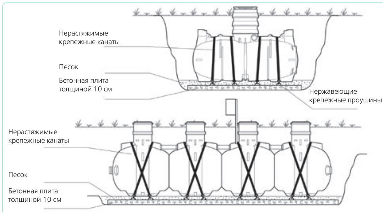
**Система анкерного крепления «Uponor»** позволяет ускорить и упростить анкерное крепление резервуаров в сложных условиях. Комплект принадлежностей для анкерного крепления включает в себя две анкерных плиты, крепежный канат и инструкцию по установке. Для анкерного крепления резервуара объемом 2 м<sup>3</sup> необходимо два комплекта принадлежностей, для крепления резервуара объемом 3 м<sup>3</sup> – три, а для крепления резервуара Установки очистки объемом 4 м<sup>3</sup> – четыре комплекта.
